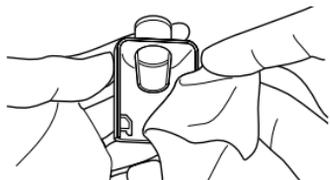
Se medicamento em excesso ficar depositado na rede, a nebulização pode ser interrompida. Nesse caso, desligue o aparelho e retire o adaptador da máscara. Retire o medicamento utilizando um pano que não solte pelos.
